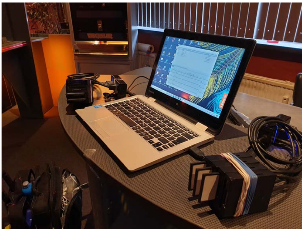
Bild 1: Gleichzeitiges Auslesen von 5 CF-Karten
